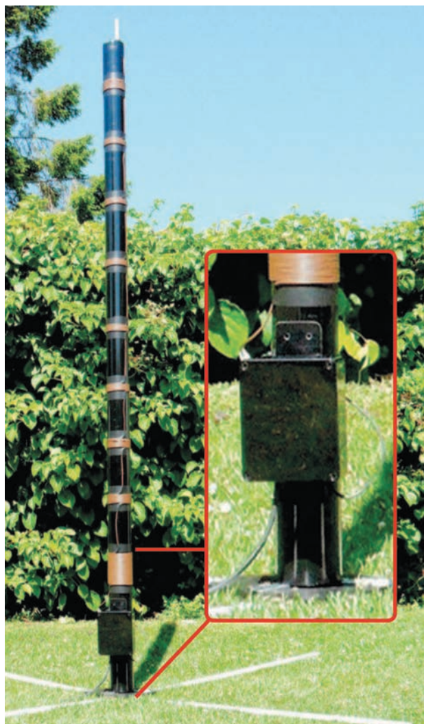
Foto 1: La antena instalada, con el detalle de la caja estanca y del montaje
