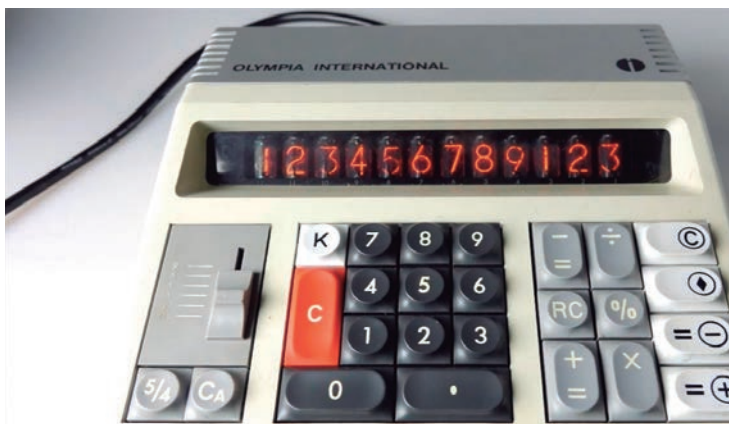
Foto 3: Calculadora con display de tubos Nixie.
