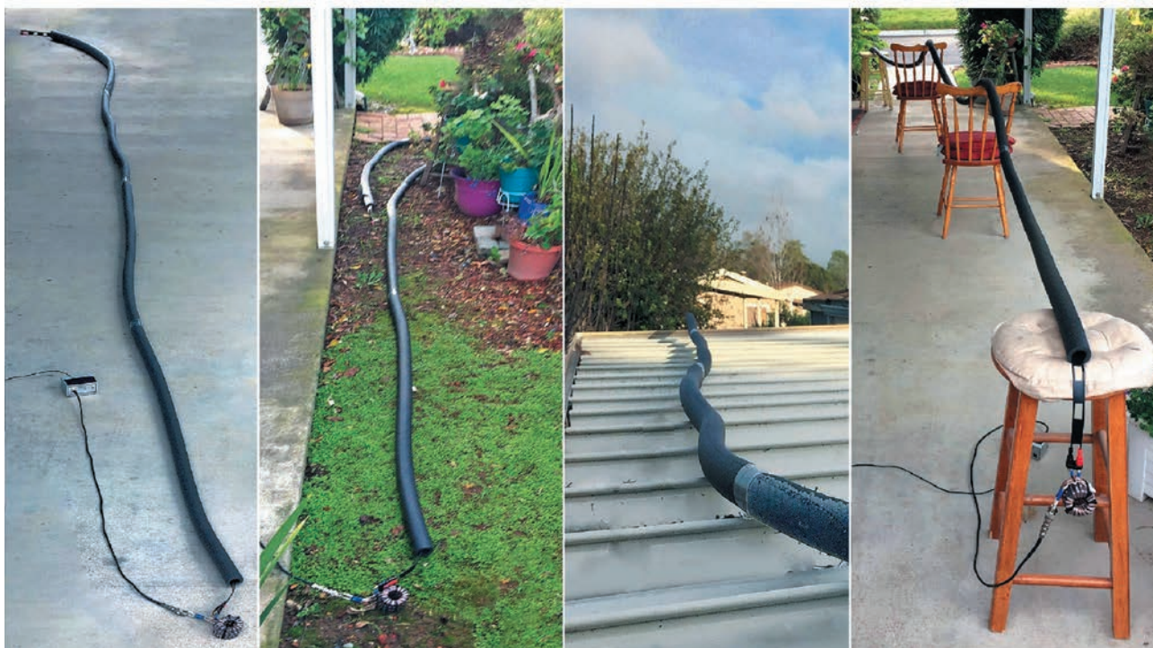
Foto 2: Condiciones de prueba. De izq. a der.: Cemento seco, césped húmedo, techo metálico y, como control, suspendida sobre un camino de cemento.
