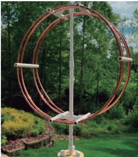
Foto 3: Estructura básica de la antena.
