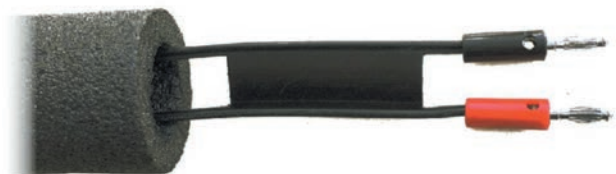
Foto 1: Hacer correr una línea ventana de 450 \Omega (también llamada "escalera" o "escalerita") por el interior de un tubo de espuma de polietileno proporciona suficiente aislación física de objetos circundantes, como para asegurar cambios mínimos en sus características.
