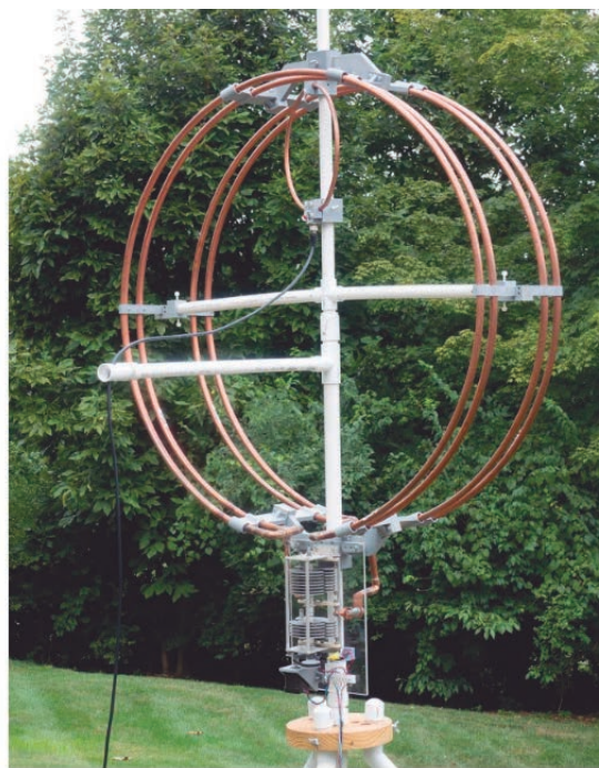
Foto 1: Versión completa del Loop Magnético Doble-Doble, utilizando una combinación de caños estándar (blancos) y piezas especiales impresas en 3D (grises).
