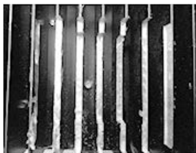
Foto 8: Las aletas del disipador se rebajan en dos pasos. Primero, 5 mm para ubicar los ventiladores. Segundo, un cuadrado de 20 mm de lado y otros 10 mm, para crear una "cámara de remolino" (ver texto y Figura 4).
