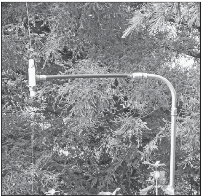
Foto 5: El dipolo activo con el preamplificador dentro de la T de PVC. El cable CAT5 blindado va por el caño.
