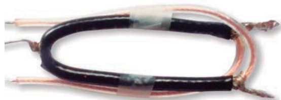
Foto 2: Bobinado interno del transformador de entrada (ver texto). El secundario es una vuelta de malla coaxial. El primario es el devanado de dos núcleos coaxiales (de los cuales una vuelta está cubierta por el devanado secundario de trenza). La conexión de bias está en el centro de la segunda vuelta secundaria, en el lado primario físico del transformador.
