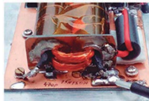
Foto 6: Transformador de salida. El final de la placa se conecta a VD. L1 está a la derecha. En VD hay capacitores de desacople adicionales conectados al plano de tierra de la placa.
