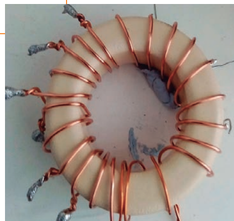
Foto 1: La bobina prototipo 3C90, con derivaciones en varios puntos para probar la relación de vueltas.
